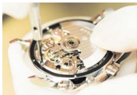
Höchstmögliche Sorgfalt und Feingefühl während des Herstellungsprozesses zeichnen eine Junghans-Uhr aus
