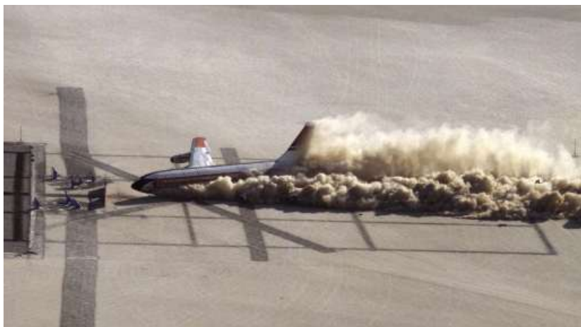
Kontrollierte Bruchlandung: Das Flugzeug, kurz bevor die Flügel aufgeschlitzt werden.
